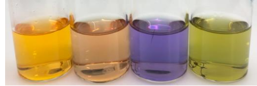
図 2. 色素 B の MeOH/H 2 O = 9/1 中での酸・塩基に対応した色変化：左から 0.1 mol/L HCl, 0.1 mmol/L HCl, 0.1 mmol/L NaOH, 0.1 mol/L NaOH.
