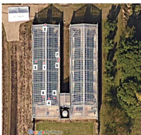
図 19. 実験 B : Beacon による位置測定データマッピング結果 (ハウス距離 20m)
