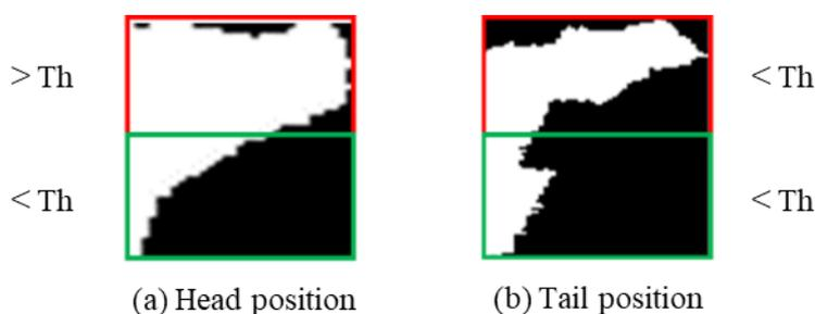
図 3.14 上下画像での白ピクセルの割合特徴を用いた処理例
