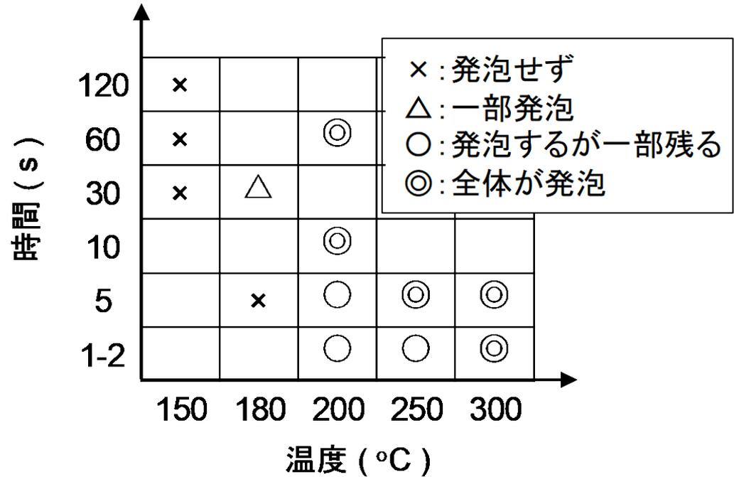
図3 粉末消火剤(020AlNa<sub>3</sub>)の天ぷら油中での発泡状態におよぼす加熱温度と処理時間との関係
