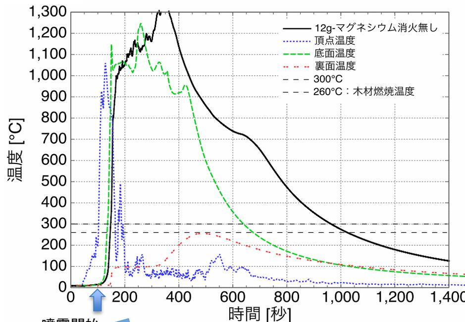
図 マグネシウムの消火実験での温度変化
