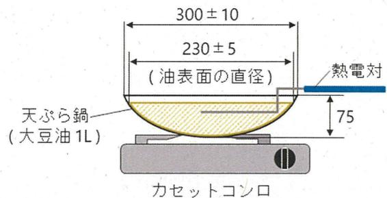
図1 天ぷら油火災の消火実験モデル
