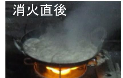
図3 液状消火剤による天ぷら油火災の消火実験
