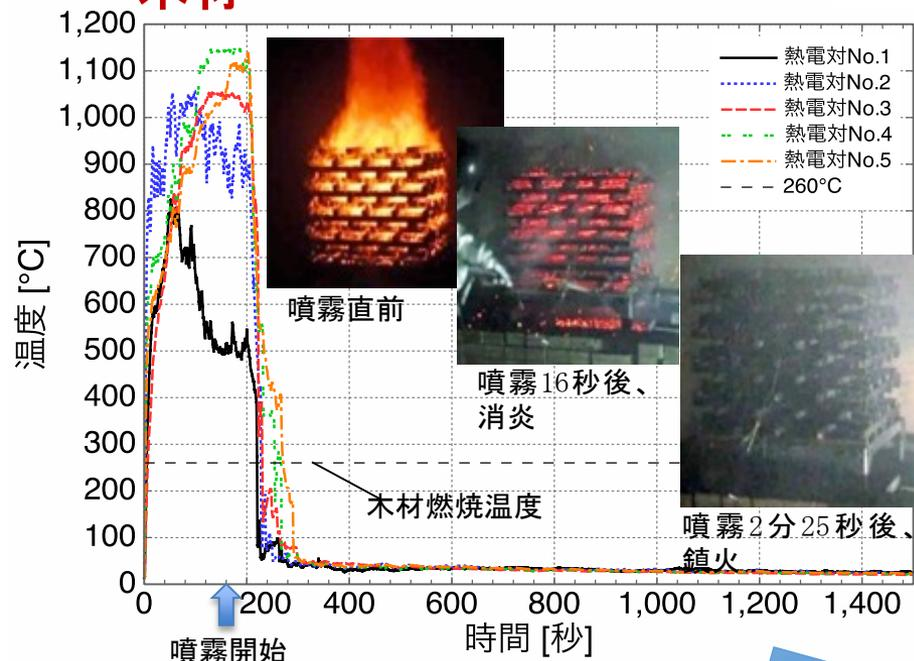
図 木材の消火実験での温度変化
