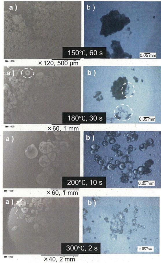
写真2 天ぷら油中で加熱処理(温度, 時間)された粉末消火剤(020AlNa<sub>3</sub>)の発泡状態の観察。 a) SEM, b)光学顕微鏡
