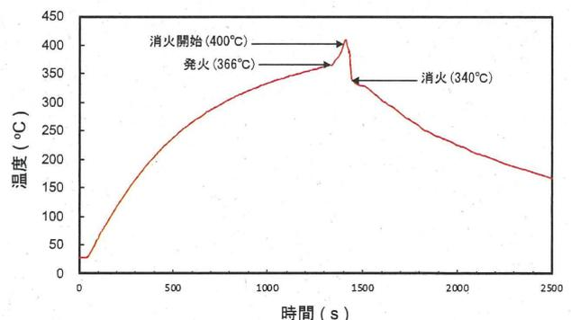
図2 天ぷら油火災消火実験モデルの消火実験での油温の変化の一例
