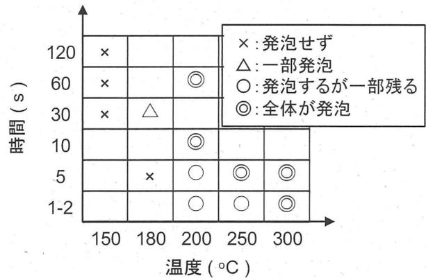
図4 粉末消火剤(020AlNa<sub>3</sub>)の天ぷら油中での発泡状態におよぼす加熱温度と処理時間との関係
