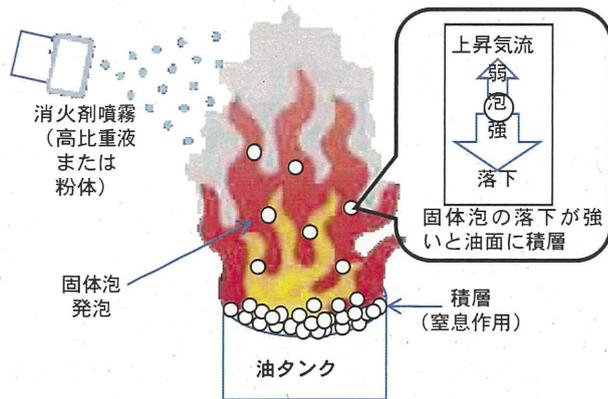
図3 感温発泡性消火剤による油火災の消火モデル
