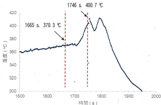
図5 天ぷら油火災の粉末消火剤の消火器による消火の際の油温の変化
