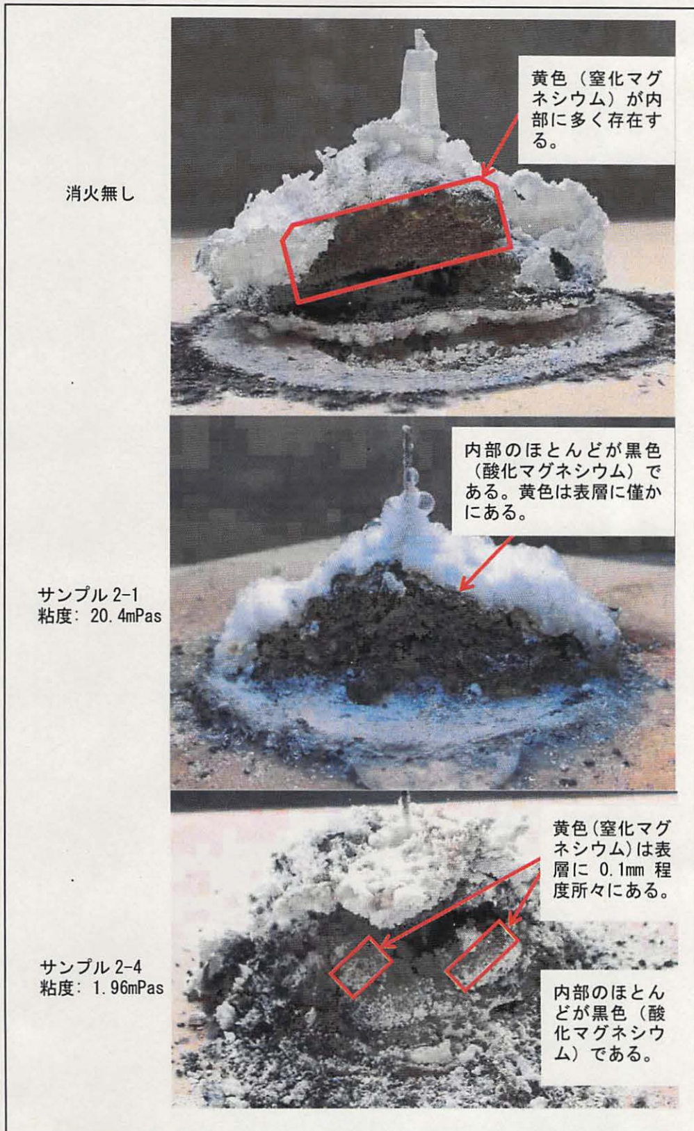
図9 消火後のマグネシウムの断面の様子
