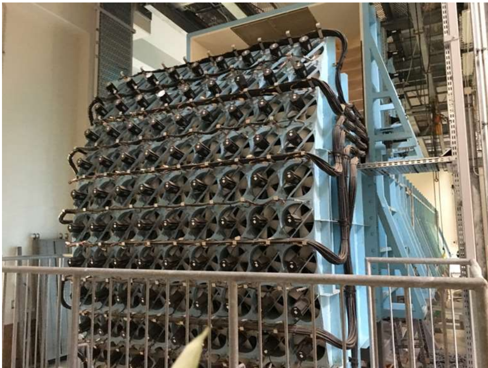
図 4.5 室内開放押し込み式マルチファン型風洞
