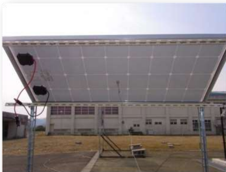
図 3.5 PV モジュールの背面（中央部に Pt100 測温抵抗体を設置）
