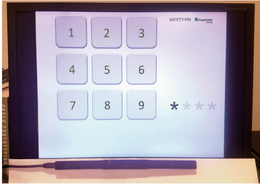
図 1. 注視による PIN 入力手法
