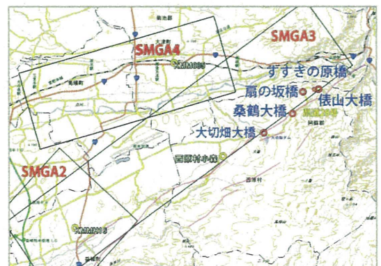
図-4 推定した震源断層と被害橋梁の位置
