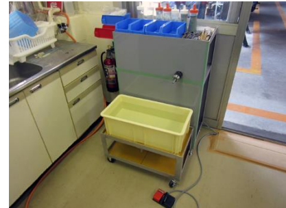
図 6. ガラス摺り加工機全景
