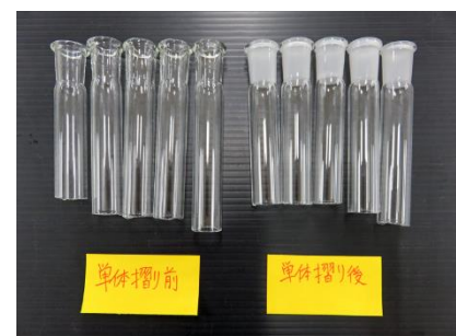
図 7. 製作した共通ジョイント
