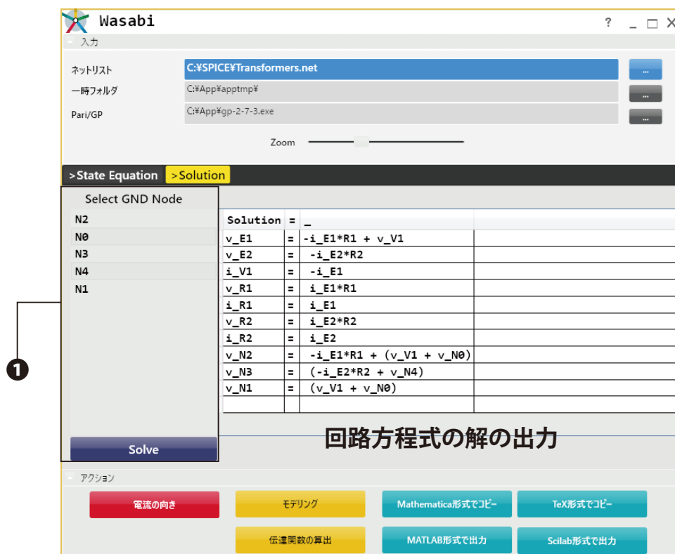
図 A.3: [>Solution] タブで回路方程式の解を算出する
