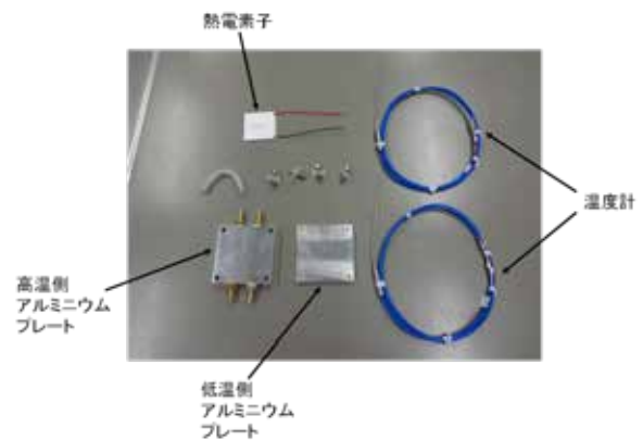
図10 熱電発電モジュールの構成部品
