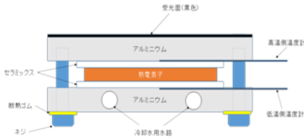
図 12 熱電発電モジュールの断面図
