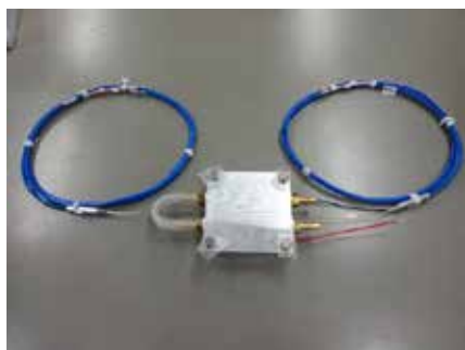
図 11 完成した熱電発電モジュール
