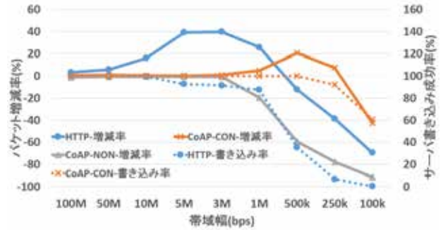
図 6. 10000 クライアントの場合の packets 増減率・サーバ書き込み率.
