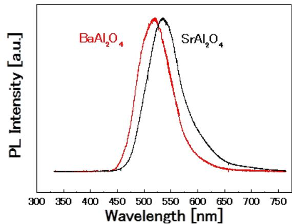
図 4.  $\text{SrAl}_2\text{O}_4$ (右)と  $\text{BaAl}_2\text{O}_4$ (左)の PL スペクトル。
