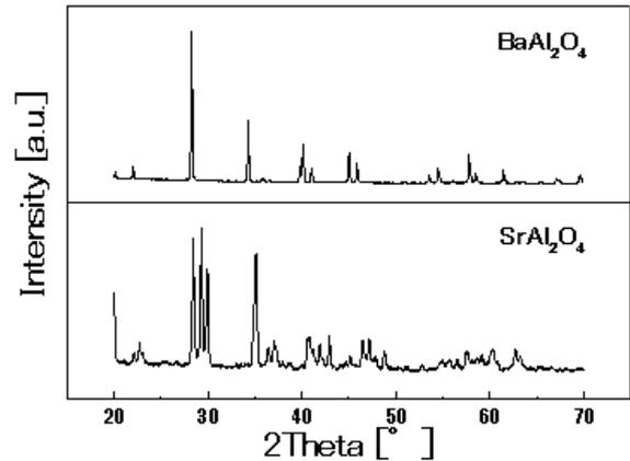
図 3.  $\text{SrAl}_2\text{O}_4$  と  $\text{BaAl}_2\text{O}_4$  試料の XRD パターン。
