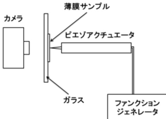
図 2. 応力発光の測定装置概略図。
