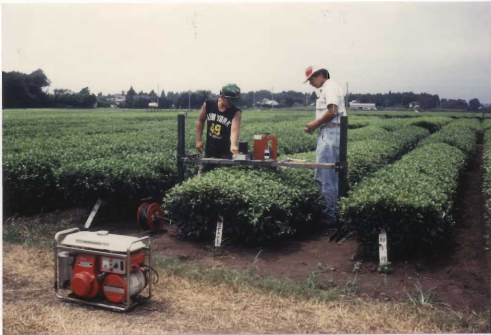
図I-7 実験風景 (写真中央がベースに固定された現場用すき試験器)
