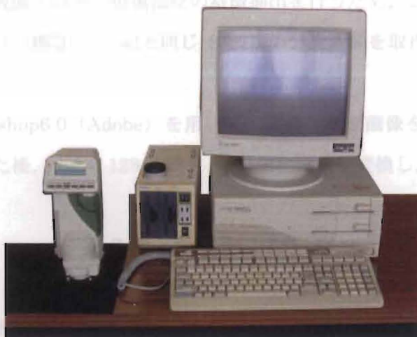
図 4-4 スペクトロフォトメーター
