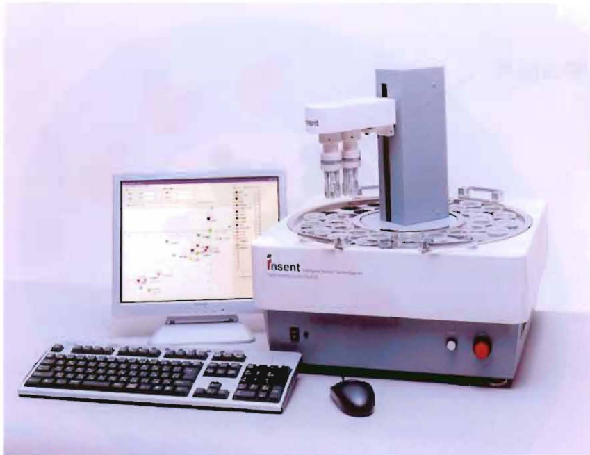
図4 マルチチャネル味覚センサ：味認識装置 SA402B
