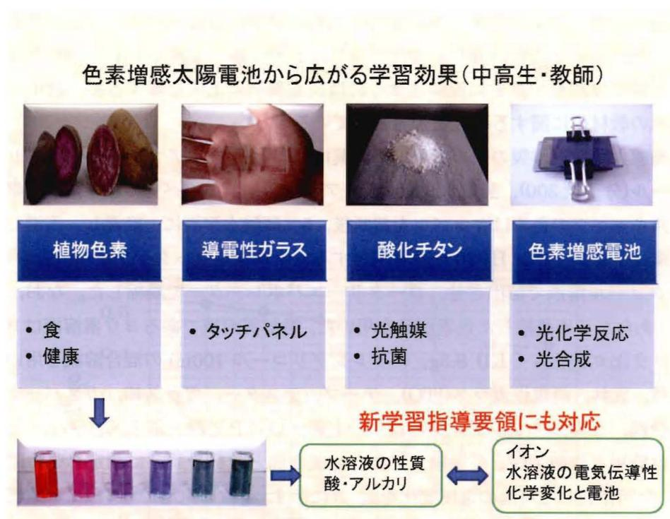
図1 色素増感電池の材料と関連する分野
