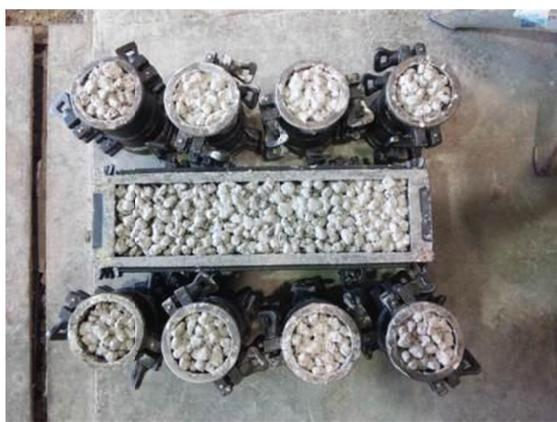
左から、火山灰モルタル（40×40×160 mm）、ポーラスタイプの藻場ブロック（直径 75 mm×高さ 150 mm）、通常タイプの藻場ブロック（サイズ同じ）です。
