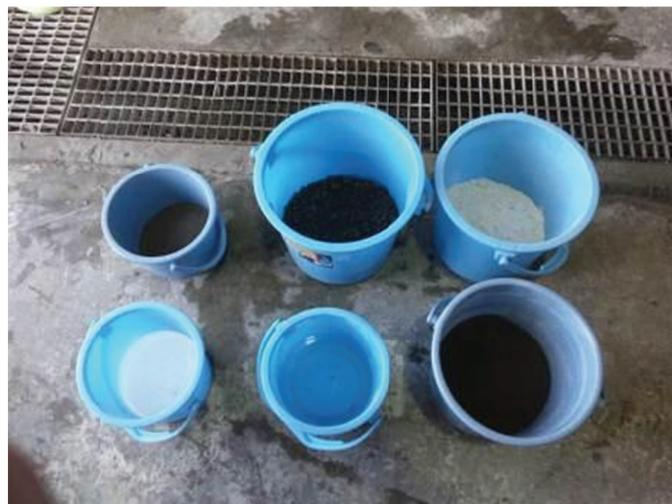
なお、この藻場ブロックにおいて、普通は火山灰ではなく、火力発電所で副生されるフライアッシュ（石炭灰）が用いられます。フライアッシュはブロック中の水酸化カルシウムと反応して固化する性質（ポゾラン反応性）があり、長期強度の向上ならびにアルカリ溶出性の低減をねらって用いられます。
