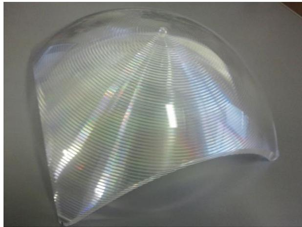
図 1.4 本研究で使用される CPV モジュールのフレネルレンズ(20 cm × 20 cm)
