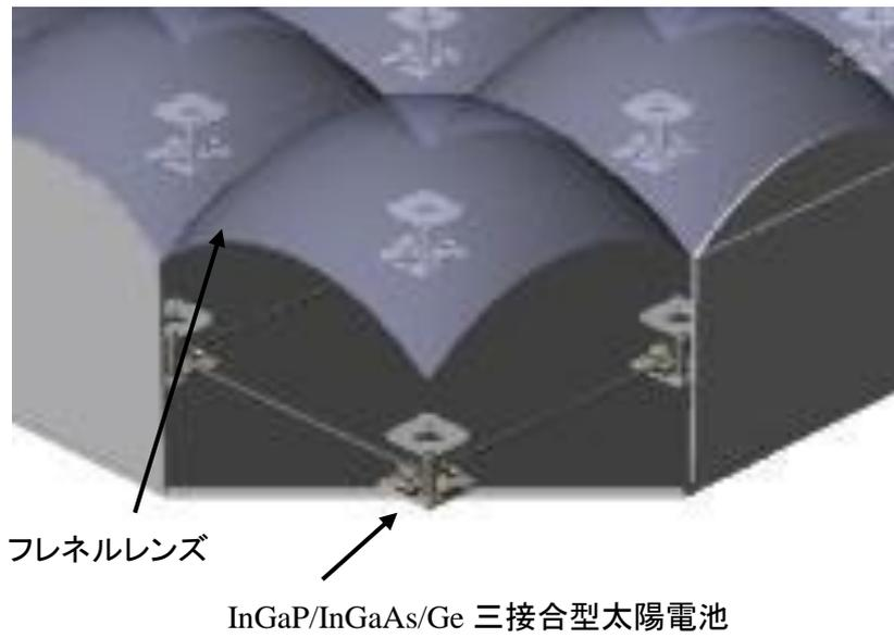
図 2.1 集光型太陽電池モジュールの模式図
