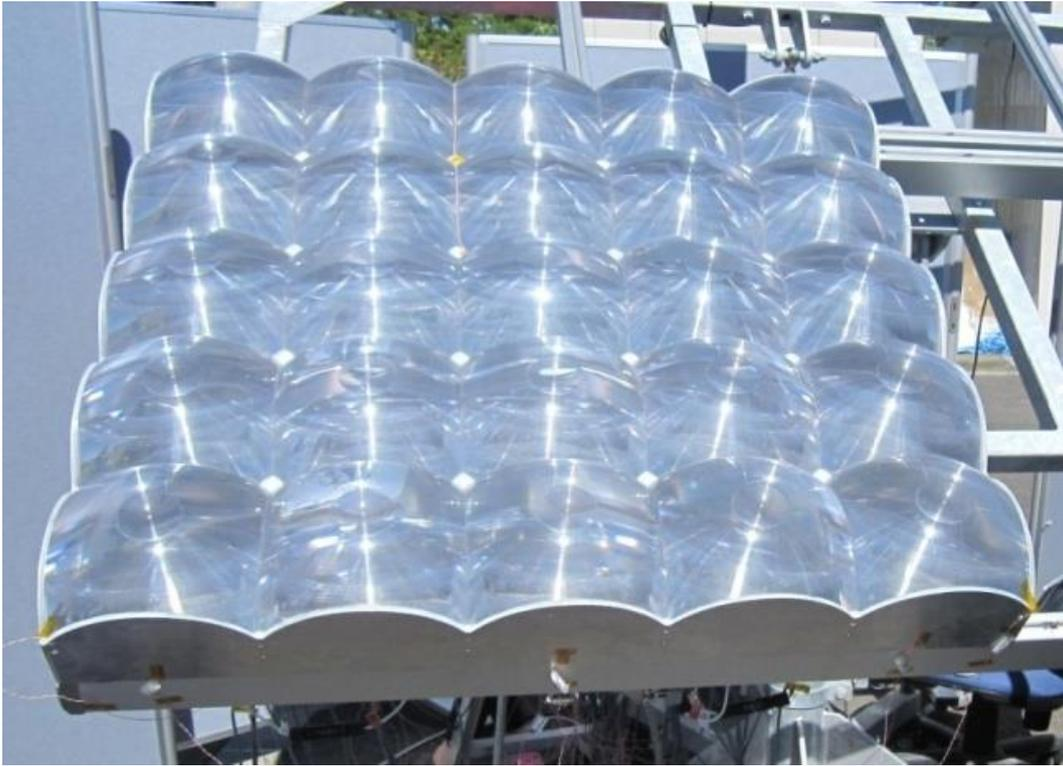
図 4.1 820 倍 CPV モジュール
