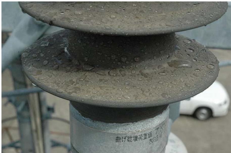
図 2.17 SiR 碍子下部の表面状態(スプレー後)
