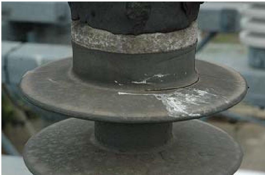
図 2.12 SiR 碍子上部の表面状態(スプレー前)
