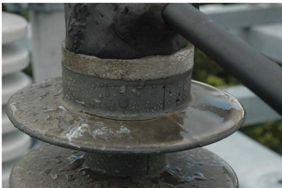
図 2.13 SiR 碍子上部の表面状態(スプレー後)
