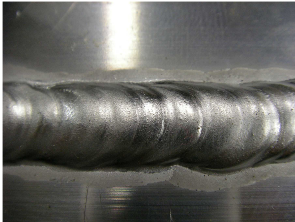
交流標準モード 電流 125A クリーニング幅 30% 交流周波数 70Hz
