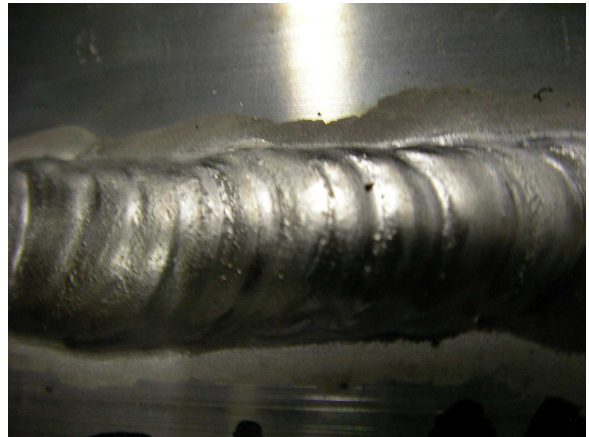
MIX TIG 電流 125A MIX 周波数 1Hz 直流比率 30%
