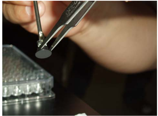
図 14 スズカプセルを使い測定試料製作。
