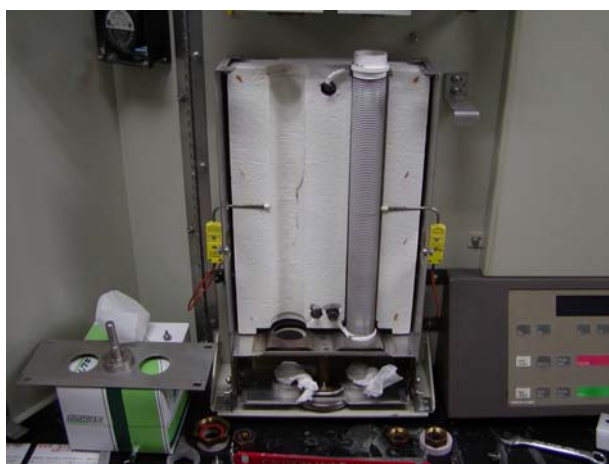
図 9 燃焼温度が 1800℃ 以上になるヒーター部分の取替。
