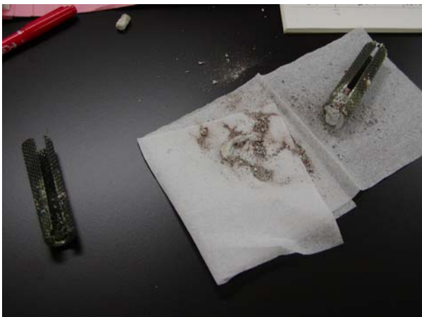
図 5 燃焼管バイアル受けの清掃.
