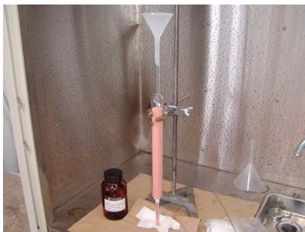
図 8 簡易ドラフト内で還元管に還元銅を充填する。
