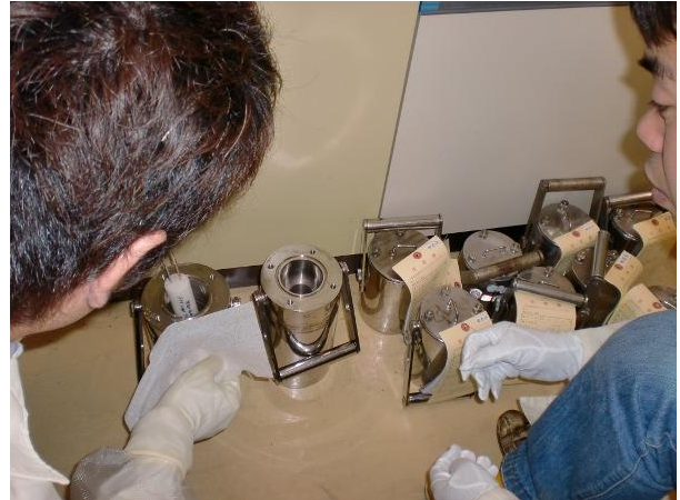
写真4 保管容器からキャプセルに入った試料を取り出す
