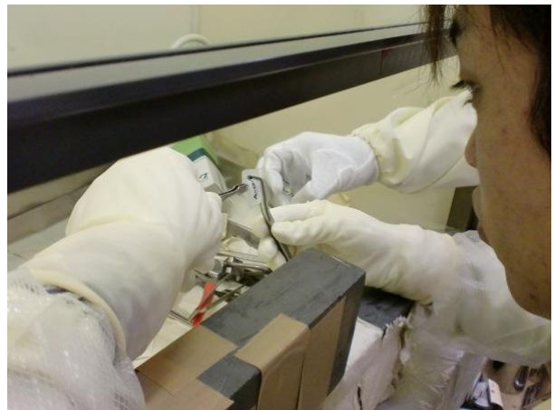
写真5 外側の袋は汚染されているので移し替える
