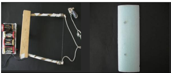
図 6(b) 半自動ヒートカッターと製作した翼
