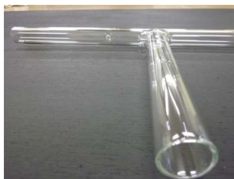
φ25mm2噴流の混合実験に使用する可視化部のT字管
