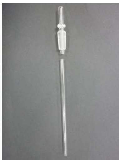
破損したトラップインナ
