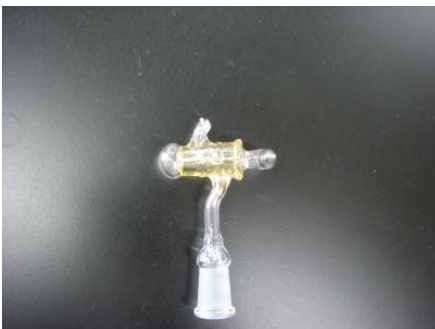
破損したガス循環式真空装置の部品
