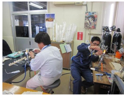
写真-5 ガラス管の追加製作状況
