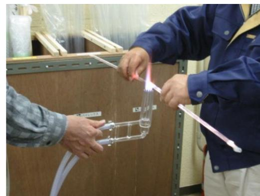
写真5 石英ガラス管の加工技術研修
