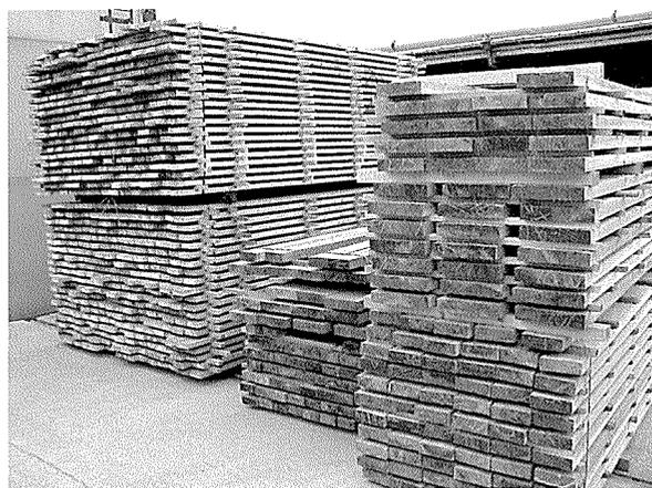
図6. 構造用集成材用のスギひき板材。
