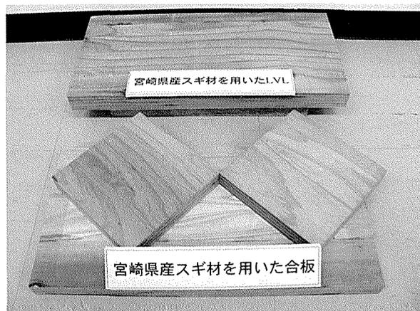
図7. 宮崎県産スギ材で試作した構造用合板・LVL（単板積層材）。
