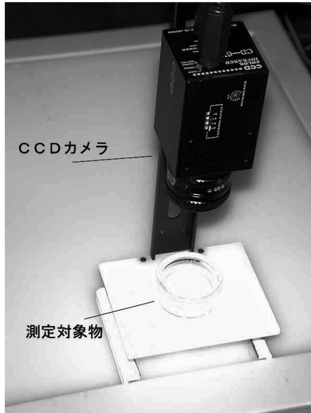
Photo.1 計測装置 (CCD カメラ部)
