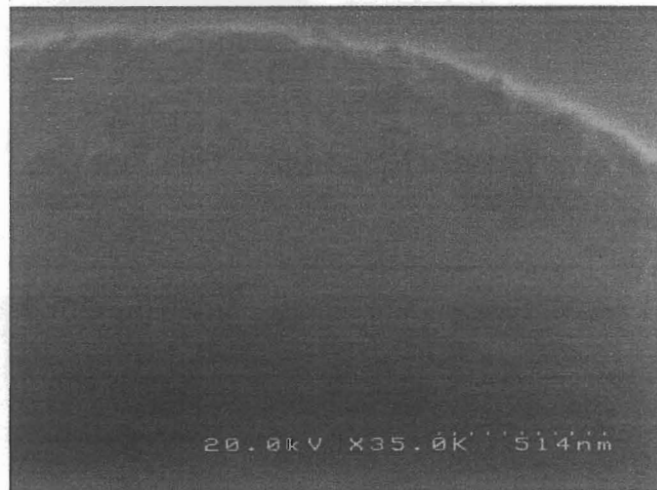
Fig. 3. 8 RIE によって作製したホールの側面 (深さ 5 \mu m、直径 5 \mu m、水平方向から 40° 傾けている)
