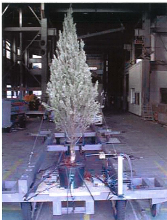
図 8.5 台車に設置された供試樹木
