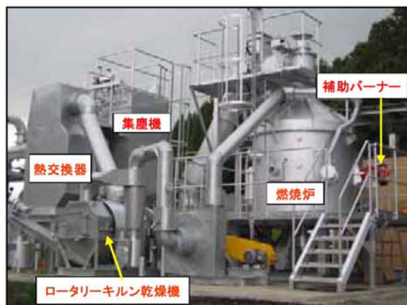
図1 燃焼システム
