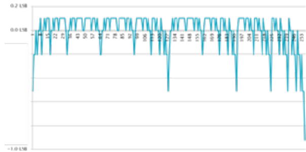
図8 容量不感 SC 循環型回路の微分非直線性誤差
