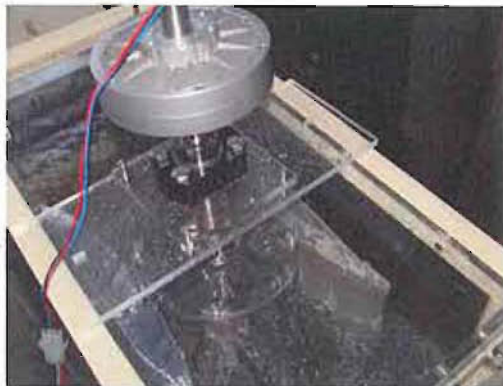
図 17. 実験用水車の流水試験の様子
