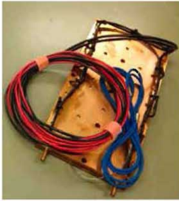
図 2.2 ゼーベックユニット(高木製作所製 SB-100B)
