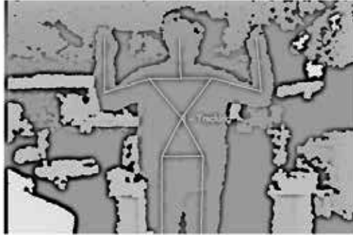
図2 kinect センサによる骨格情報の取得
