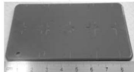
図12 ABS樹脂におけるニッケルめっきの様子(処理工程①).
