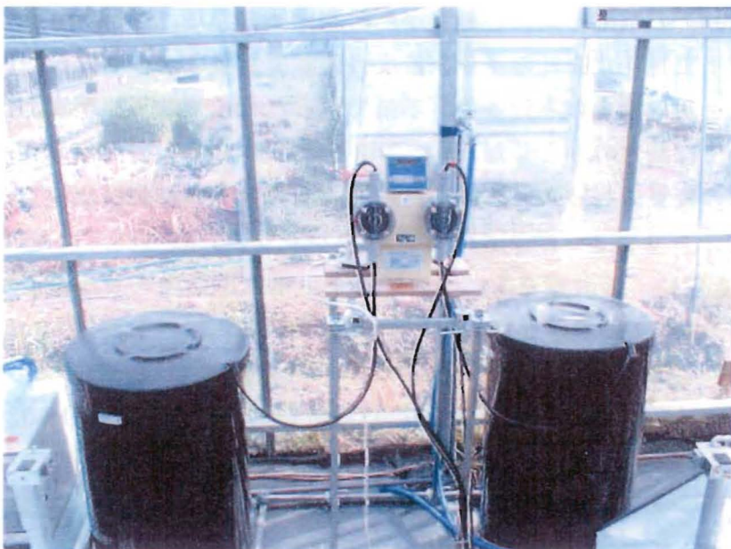
第 5-2-8 図. EC 制御装置
