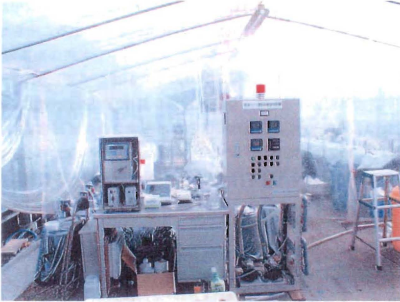
第 5-2-7 図. イオン濃度制御装置
