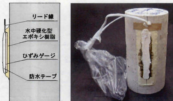
図-1 ひずみゲージの貼付方法（左）と実際の貼付状況（右）
