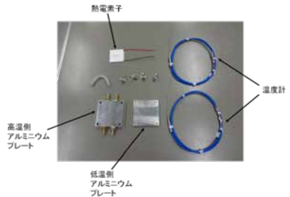
図10 熱電発電モジュールの構成部品
