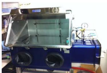
図10 フロー型グローブボックス
