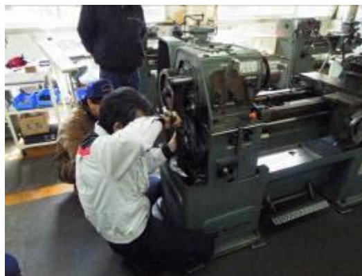
図 8 外部委託による送りギア交換の立会い
