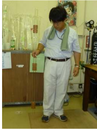
平成 21 年度に続き依頼された \phi 6 \times 1500\text{mmU} 字管マンノメーター
