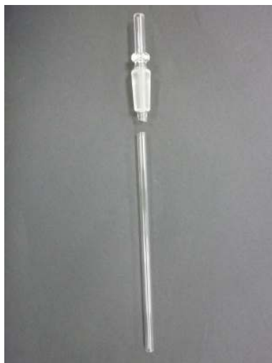
破損したトラップインナ
