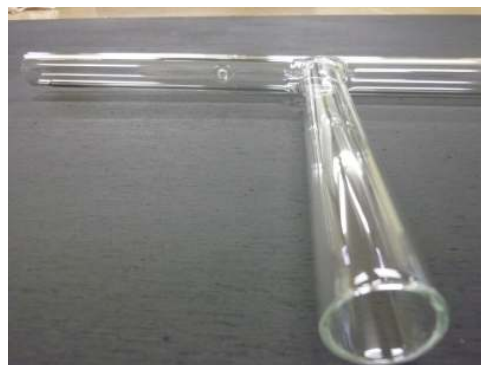
φ25mm2噴流の混合実験に使用する可視化部のT字管
