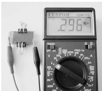
図1 組み立てた色素増感太陽電池
