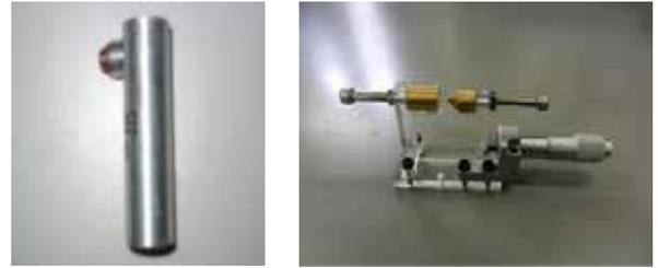
(a) AE センサ (b)模擬放電電極
