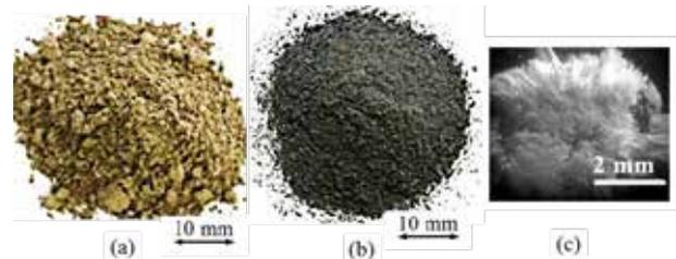
図 2. 試験片に用いた原材料, (a) 粘土, (b) 粉砕した GFRP, (c) GFRP に含まれているガラス繊維
