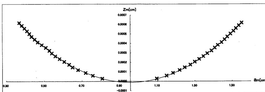
図3. レンズの断面のプロット (データ1) と円の式でのフィット
