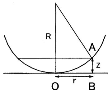
図2. レンズの曲率半径と空気層の厚さの幾何学的関係
