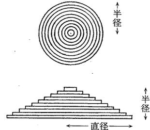
図3. 球(上)と同体積の円錐(下)の断面積
