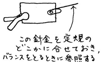
円と正方形を吊り下げて、監視カメラの指示針が基準点を指示するように円と正方形の位置を左右に動かしてバランスさせます。
